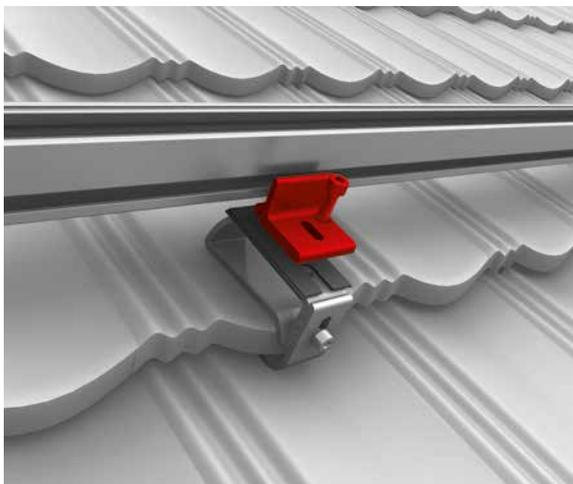
Die Montageschiene wird auf dem Dachhaken mit Hilfe des K2 Climbers und der Zylinderschraube mit Unterkopfverzahnung montiert. Anzugsdrehmoment 16 Nm. Aufgrund der thermischen Ausdehnung müssen die Reihen nach max. 17,6 m getrennt werden. Der Mindestabstand für die Trennung zwischen zwei K2 Schienen beträgt 3 - 5 cm.
