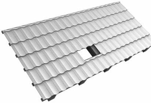
Die Sparren, auf welchen die Dachhaken befestigt werden sollen, müssen freigelegt werden. Bei einer Verschalung muss die Position der darunterliegenden Sparren festgestellt werden, damit eine Befestigung der Dachhaken in die Sparren gewährleistet wird.
