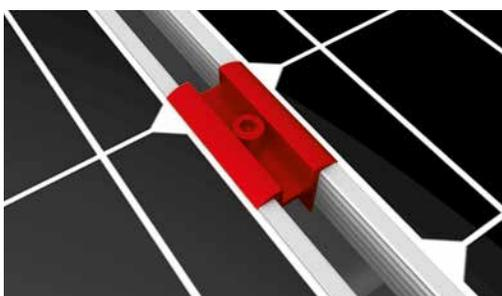
Zwischen zwei Modulen jeweils zwei OneMid Universal-mittelklemmen verwenden. Dazu den Stance der Klemmen in die Nut einklicken. Klemmen an die Modulrahmen anlegen und fixieren. Anzugsdrehmoment: 14 Nm
