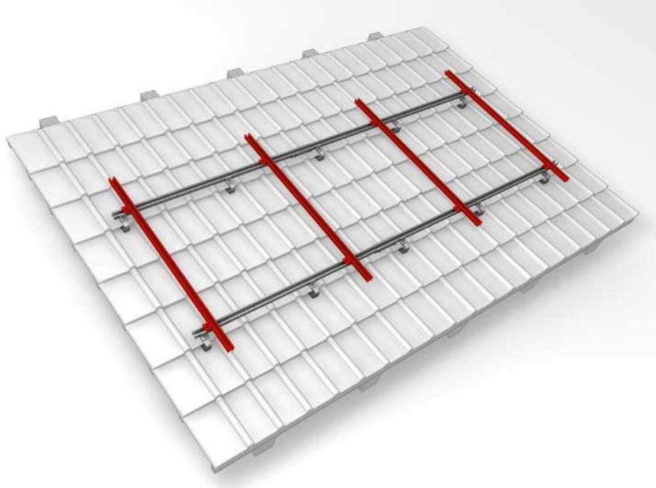
Die obere Schienenlage im Kreuzverbund wird mit Hilfe der MK2 Einlegemutter, dem Climber und der Zylinderschraube mit Unterkopfverzahnung M8 an der gewünschten Stelle und in entsprechendem Abstand montiert. Anzugsdrehmoment 16 Nm
