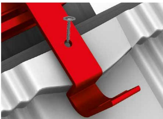
Der Bügel wird zusätzlich mit einer selbstbohrenden Schraube in der Lattung verschraubt. (sich befindliche Nägel in diesem Bereich müssen vorher entfernt werden) Anzugsdrehmoment anschlagorientiert.
