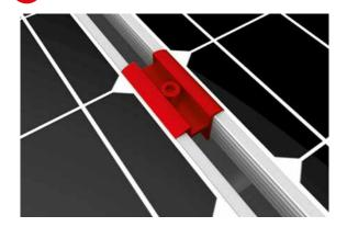
**Fixation avec étriers universels intermédiaires K2 Clamp MC/OneMid:** entre deux modules, utiliser deux étriers universels intermédiaires. Cliquer la base de l'étrier dans la cavité du rail. Fixer l'étrier au cadre du module. Respecter les indications de fixation du fabricant du module.
