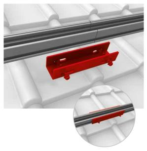
Poser les Rail de montage bout à bout et assembler à l'aide du connecteur de rails et des vis à tête marteau et écrous de blocage. Le joint entre les rails ne doit pas être situé dans la zone du crochet.
