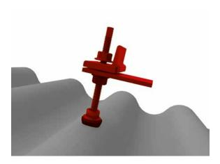
Visser l'écrou double sécurité situé sous la tôle d'adaptation /L-adapter de manière à obtenir la position nécessaire pour fixer la hauteur de la tôle d'adaptation /L-adapter.
