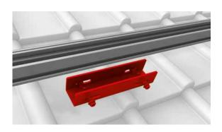
Poser les Rail de montage bout à bout et assembler à l'aide du connecteur de rails et des vis à tête marteau et écrous de blocage. Le joint entre les rails ne doit pas être situé dans la zone du crochet.
