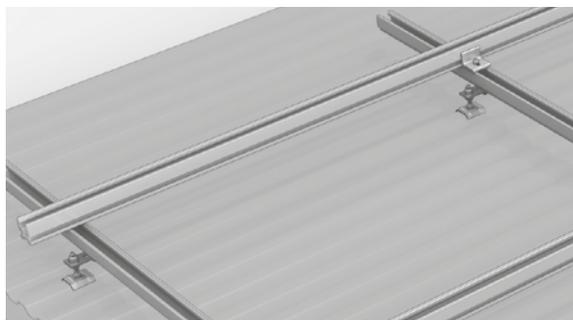
Fixer à l'aide du Climber le CrossRail ou le SingleRail en tant que rail supérieur suivant le schéma ci-dessous. L'écartement des rails se fait en fonction des résultats du logiciel de calcul.
