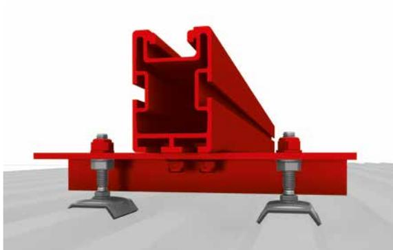
Le K2 Bridge est monté à la place de la tôle d'adaptation sur deux vis à double filetage. Cela permet de réaliser des envergures plus importantes. En fonction du type de rail, celui-ci est fixé sur le Bridge par une ou deux vis à tête marteau M10x30.
