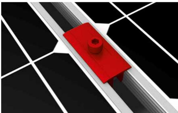
**Blocage avec l'étrier intermédiaire XS:** Entre deux modules, utiliser deux étriers intermédiaires XS qui doivent être vissés sur les écrous prisonniers avec des vis DIN 912 M8.
