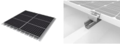
Sickenabstand unabhängiges flexibles Photovoltaik-Montagesystem für Trapezblecheindeckung oder Sandwich-Paneele. Dachanbindung und Montageschiene in einem Bauteil. Mit Selbstbohrenden Blechschrauben (abZ) wird die Montageschiene in der Dachhaut auf den Hochsicken befestigt. Bauteil in unterschiedlichen Längen (10 oder 25 cm). Universelle Modulklemmung (30-42 mm)
